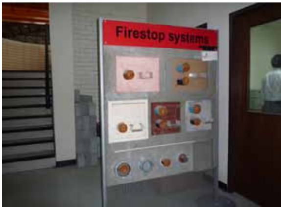
区画貫通部処理の紹介（？試験体？）
