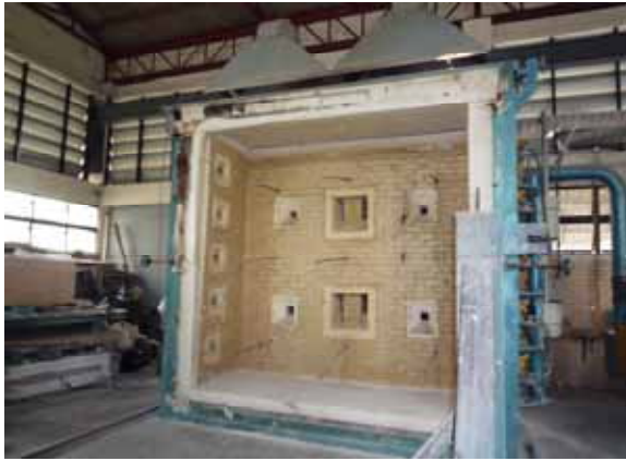
大型壁炉（炉内寸法は約 3m 角強）
