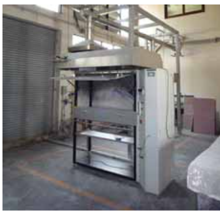
床材の水平方向延焼性状試験装置
