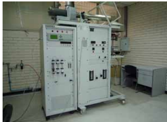
コーンカロリメータ試験装置
