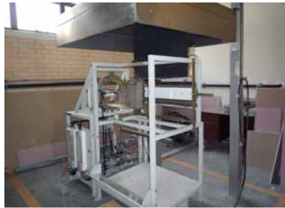
壁材の水平方向延焼性状試験装置
