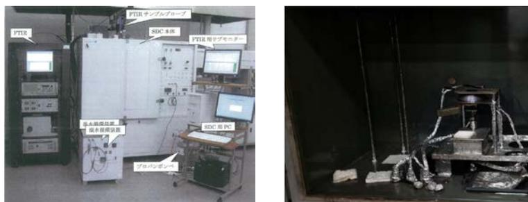
図 2 FT - IR 装置および Smoke Density Chamber 装置内部 (東京理科大学)
