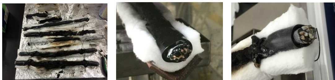
図2 加熱試験後の試料（左：全容，中央および右：試料端の拡大写真）
