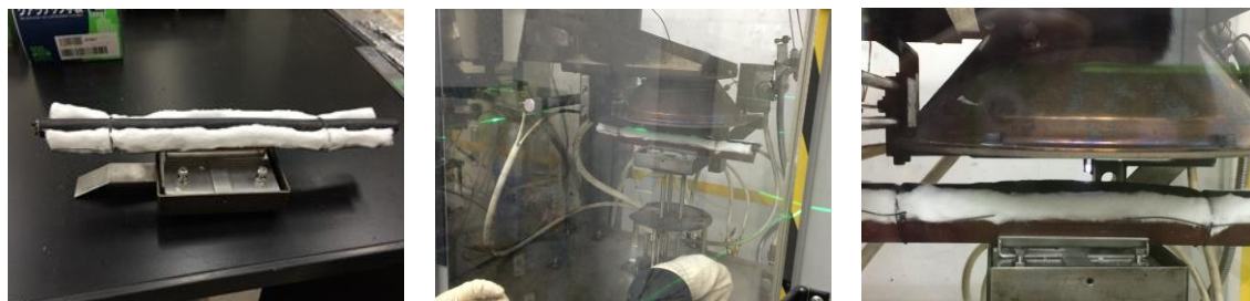
図1 コーンカロリメータ試験（左：試験体，中央：試験装置全体，右：試験時の様子）
