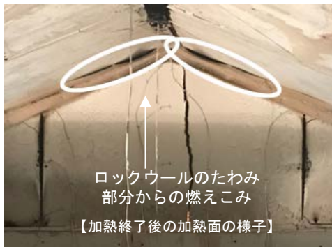
写真4 せっこうボード(GB-R) 加熱面ロックウールの間に隙間が生じた
