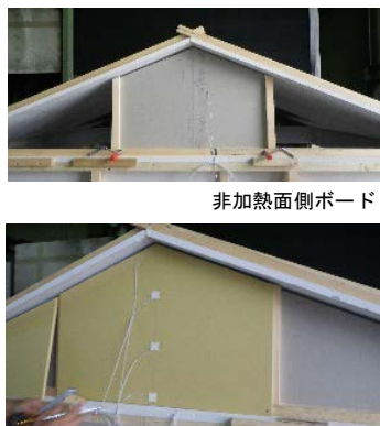
写真2 界壁面パネル
