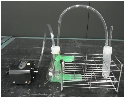
図3. タバコ培養細胞煙暴露装置（左） 発煙性試験装置内部に設置後（右）
