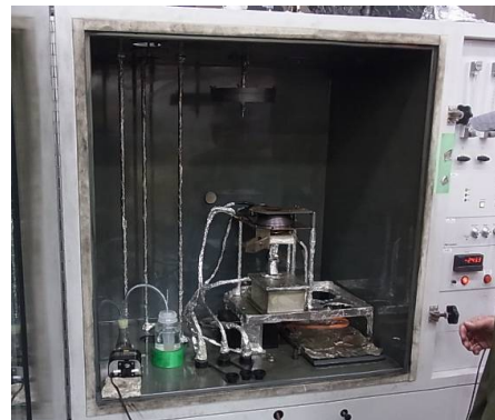
図3. タバコ培養細胞煙暴露装置（左） 発煙性試験装置内部に設置後（右）
