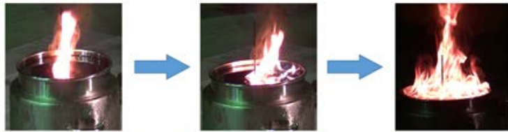
水面上の高引火点液体(重油)の火災拡大
