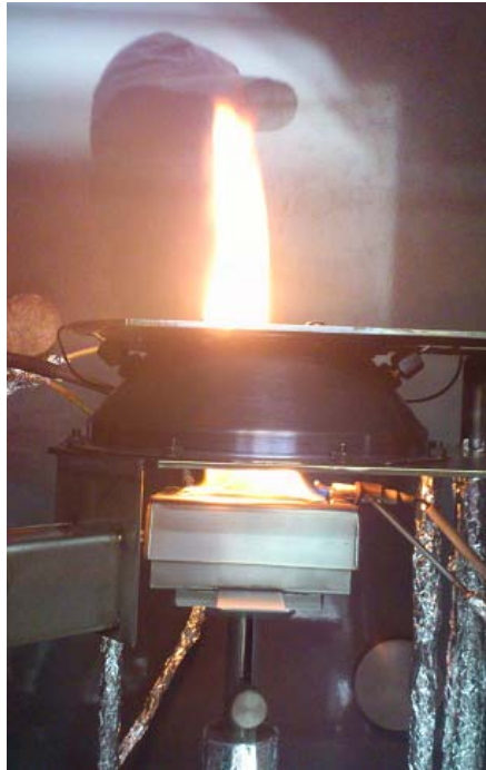
図1. 木材片を用いた燃焼実験の様子。木材表面への泡消火剤の有無により燃焼ガス組成および燃焼ガスの細胞毒性が大きく変化した。
