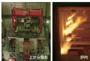
#003で紹介した大型壁炉とも連動させて、梁、壁、柱、屋根、床などの建築部材に対し、ISO規格に沿った載荷加熱・耐火試験が総合的に行えるよう、複合型多目的水平炉として2010年3月に構築した装置である。(文/技術者・棚池裕)
