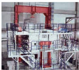
多目的水平載荷加熱試験装置 最大定格燃焼熱量：約2900kJ/h 最大加力能力：5MN
