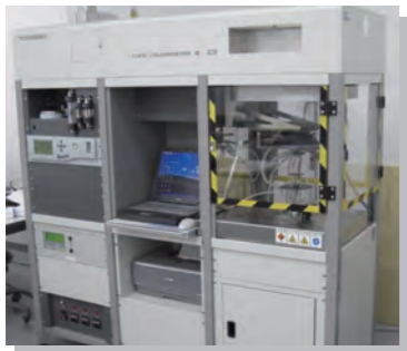
コーンカロリメータ 熱放射：0～50kW/m 2 加熱能力：10～100kW/m 2
