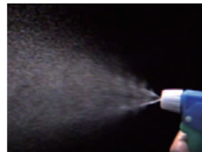
図1 渦巻き弁の粒子ができるまでの過程
