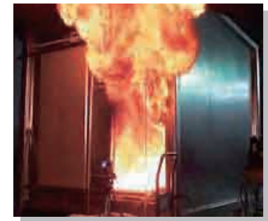
ルームコーナー試験装置 幅・高さ：2.4メートル 奥行き：3.6メートル
