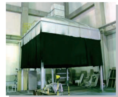
燃烧熱量測定用フード 測定発熱量：最大 3MW 吸煙量：最大 600m 3 /min
