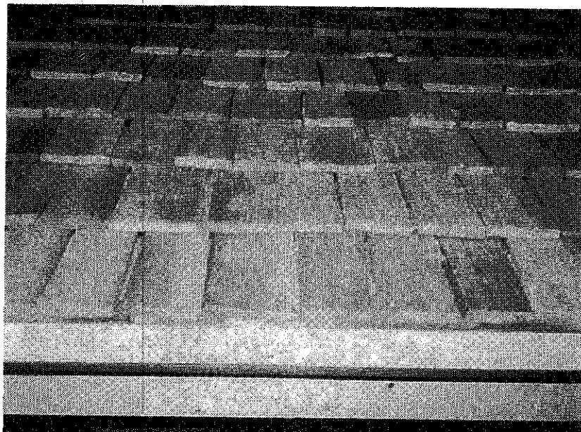
写真5 防火試験中の木製屋根
