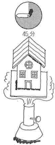
耐火構造：木造3階建て共同住宅が認められる準耐火構造：準耐火構造
