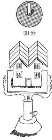
耐火構造：木造3階建て共同住宅が認められる準耐火構造：準耐火構造
