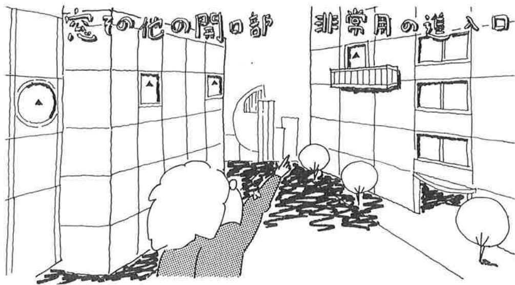
ビルの窓にある赤色の三角形のマークは消防隊進入口である
