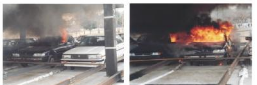
a) 出火車両の燃焼 b) 隣接車両への燃え広がり
