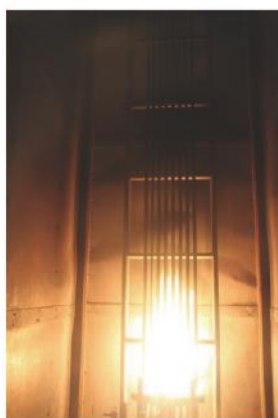
図11 EN50399 による電線の燃焼性試験
