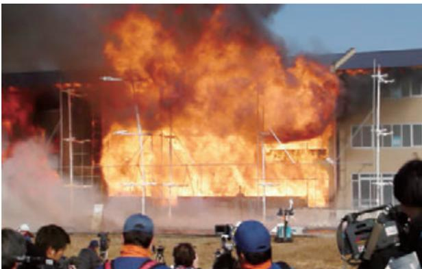
図 3階建て木造校舎の火災実験(平成24年2月) (筆者撮影)
