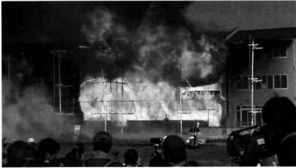
写真1 3階建て木造校舎の火災実験（2012年2月、建築研究所）筆者撮影
