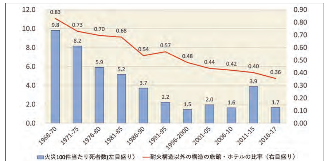
図6 旅館・ホテル等の火災100件当たり死者数と耐火構造以外の構造のものの比率の推移(1968-2017)(消防白書より作成)
