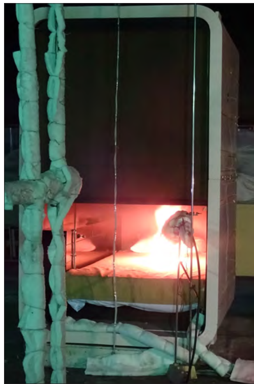
図2 カプセルホテルのユニット燃焼実験（2019年11月22日 於建築研究所）（主催者：NPO法人日本防火技術者協会）
