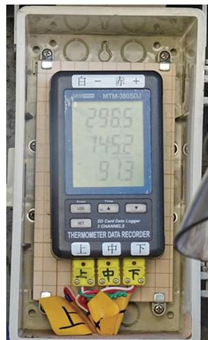
図7 火災室外部に設けられた温度計(上から天井部分296.5度、床上1.5メートル部分145度、床上1.1メートル部分91.3度)
