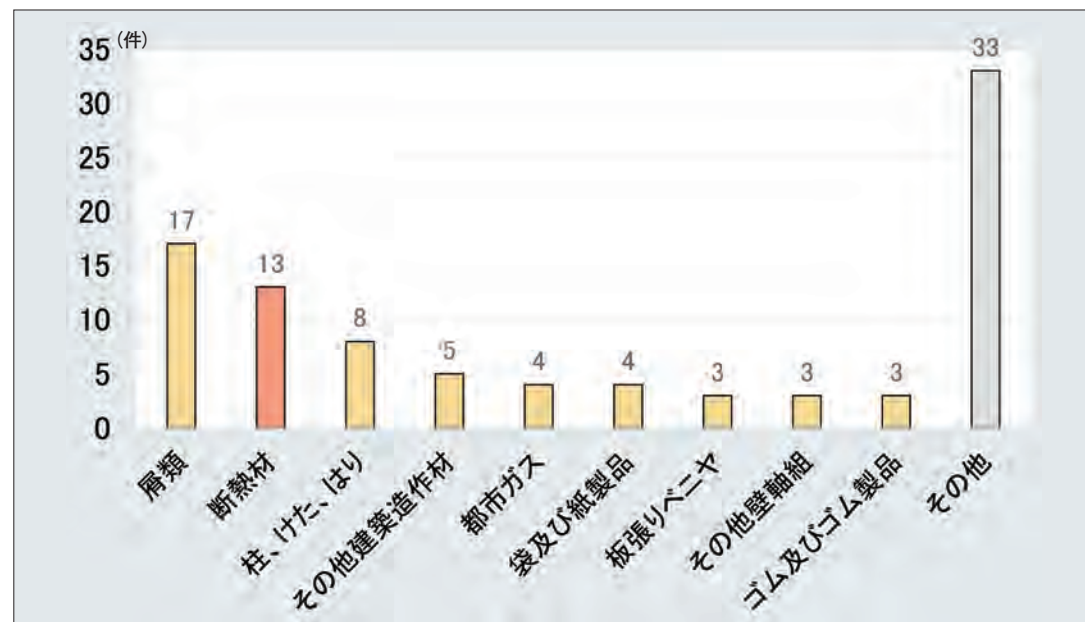
図3 溶接・溶断関係工事中の建物火災の着火物別火災件数(2019 n=93) (消防庁火災報告データより作成)
