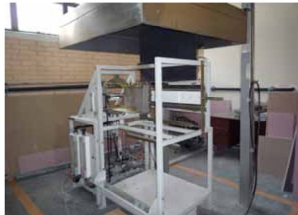
壁材の水平方向延焼性状試験装置
