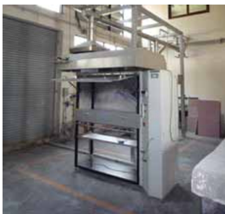
床材の水平方向延焼性状試験装置
