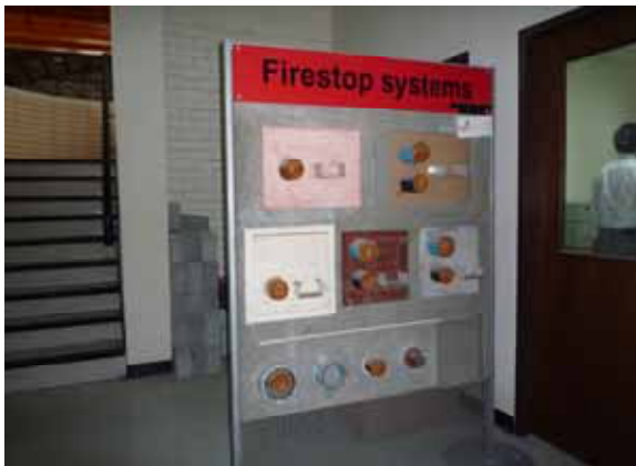
区画貫通部処理の紹介（？試験体？）
