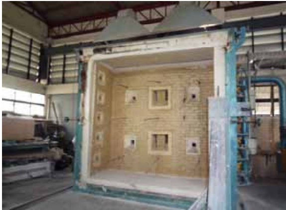
大型壁炉（炉内寸法は約 3m 角強）
