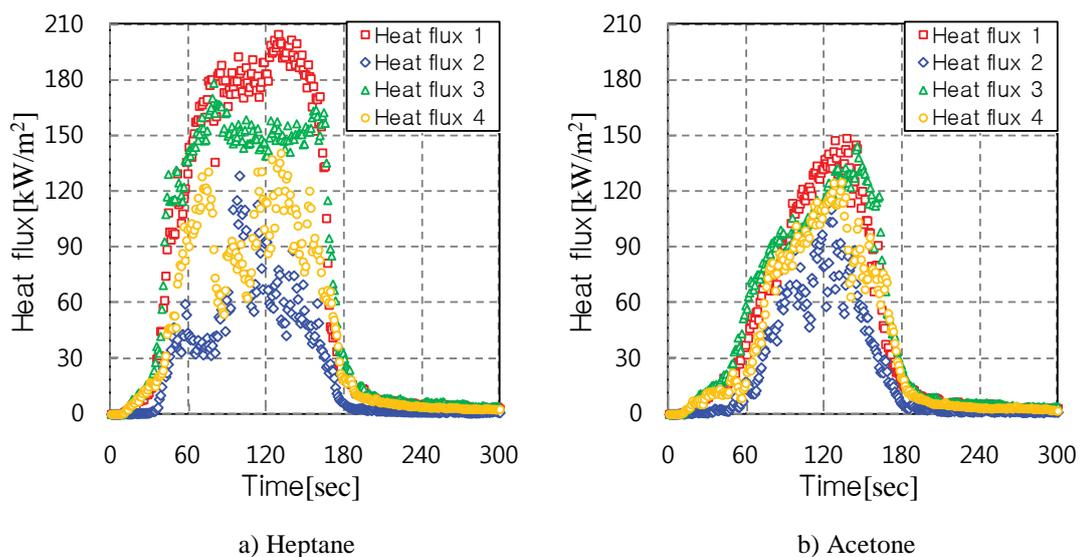
図 11 Façade の熱流束測定結果
