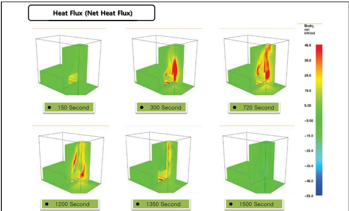
図8 解析の熱流束結果
