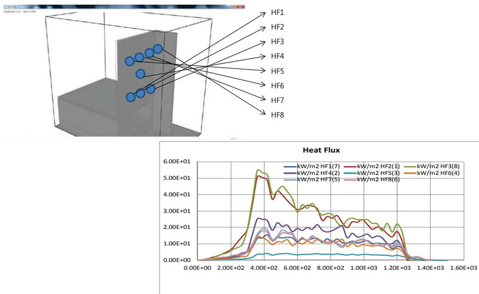
図 5 解析の熱流束結果
