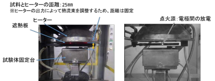
図 1 点火直前の状態(左) 点火源投入中の状態(右)
