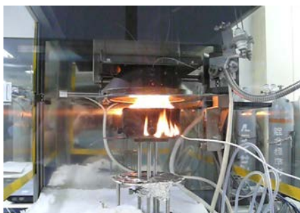
図 4 コーンカロリメーター試験(左)と爆裂や着火の発生有無判定予備試験(右)
