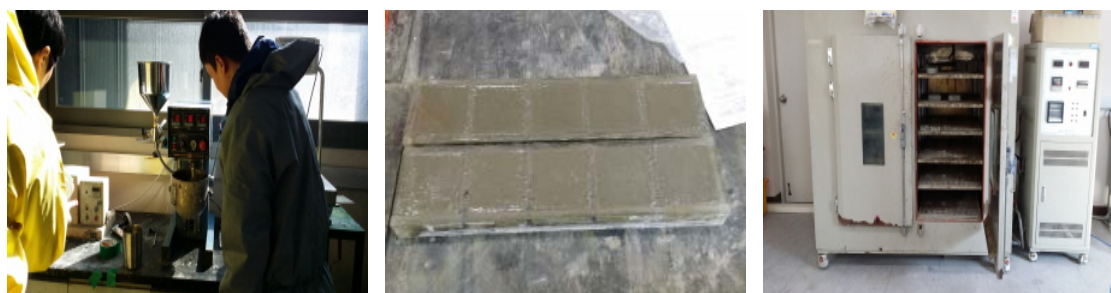
図 3 練り混ぜ、試験体 (KCL 製作)、養生機装置 (韓国建設生活環境試験研究院)
