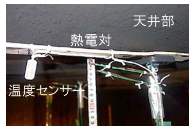
写真 2 測定センサー
