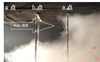
(1)吹き出し風速 3m/s : 実験 3
