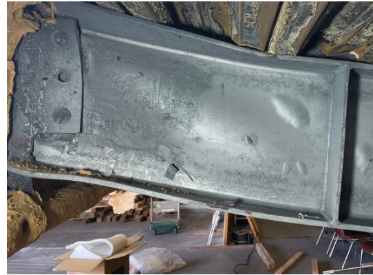
写真3 実験後のガセットプレートの損傷の様子
