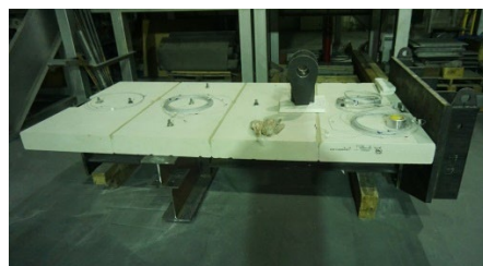
2018 年度試験体 (スラブ無し (上部 ALC 版))
