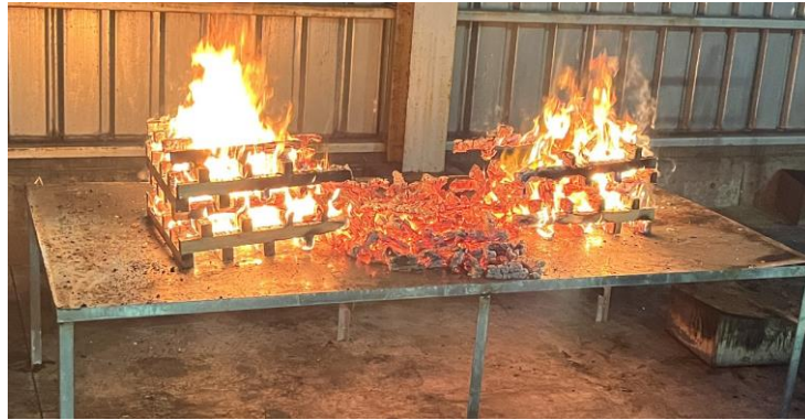
図5 木材クリブを用いた延焼試験 ゲル消火剤を散布したクリブ 水を散布したクリブ
