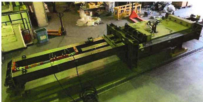
図3 加熱炉設置前の試験体と加力治具
