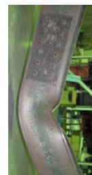
写真 柱接合部試験体の試験後
