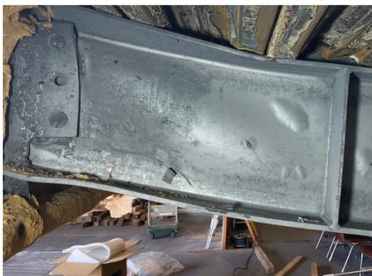
写真 1 2021 年度実験の無耐火被覆小梁端部の損傷状況
